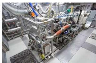
Wasserstoffmotor auf dem Prüfstand: Seine Expertise für Verbrennungsmotoren nutzt MAHLE, um den Weg für nachhaltige Kraftstoffe motorseitig frei zu machen.
